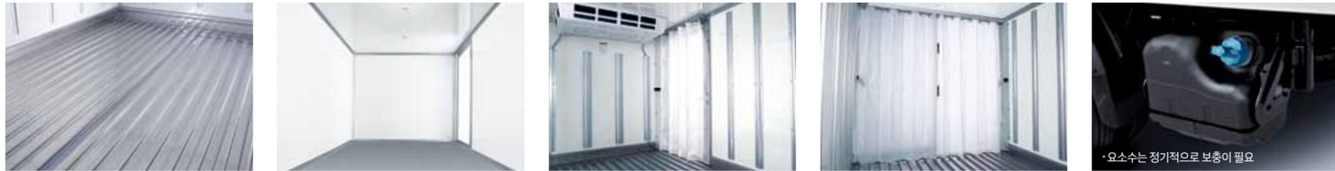
요철형 스테인레스 바닥(냉동탑차) -SUS304 화물실 및 고압축목재 바닥재 (내장, 외바디 등) 사이드 도어 보냉커튼 리어도어 보냉커튼
